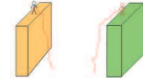
[для того чтобы протянуть кабель между двумя домами, понадобится длинная веревка, разделенная напополам]
