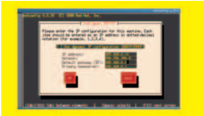
[утилита netconfig позволяет в считанные секунды поднять сетевой интерфейс]
