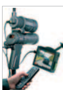
[радар «Искра-видео» фиксирует факты нарушения на флешку]
